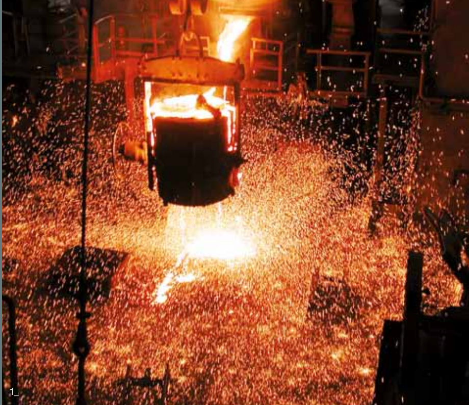
1_ Flüssiges Metall wird aus einem Elektrolichtbogenofen abgegossen.
